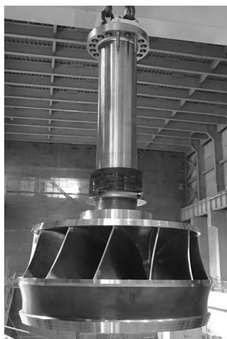
Fig. 5 ラオス国 ナムニアップ1主発電所 立軸フランシス水車
