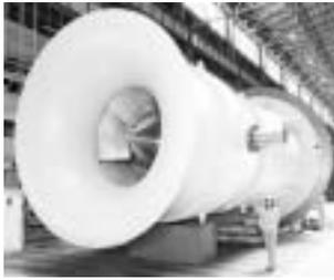
図7 中国ノ三門原子力発電所向け循環水ポンプ(三菱)
