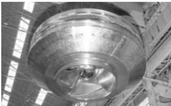
関西電力㈱では、固定電源の比率が増加する夜間の周波数調整量確保に加え、将来増加が想定される再生可能エネルギーの出力変動を見据え、奥多々良木揚水発電所で既設定速機2台の可変速化改良を計画している。写真は、新たに設計された中間羽根付き2分割ポンプ水車ランナ(4枚+4枚羽根)で、可変速化後の入出力は311.7 MW、旧ランナに比べて部分負荷効率改善と運転範囲拡大も実現している。1台目のランナは平成22年より定速機として運用しており、可変速機としての運用開始は、1台目が平成26年、2台目が平成27年の予定である。
