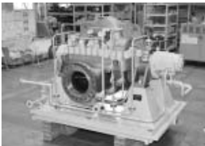
Fig. 3 LPG回収プラント脱硫装置用 アミン溶剤ポンプ (三菱)
