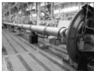
図2 400mm立軸斜流ポンプ(荏原)
